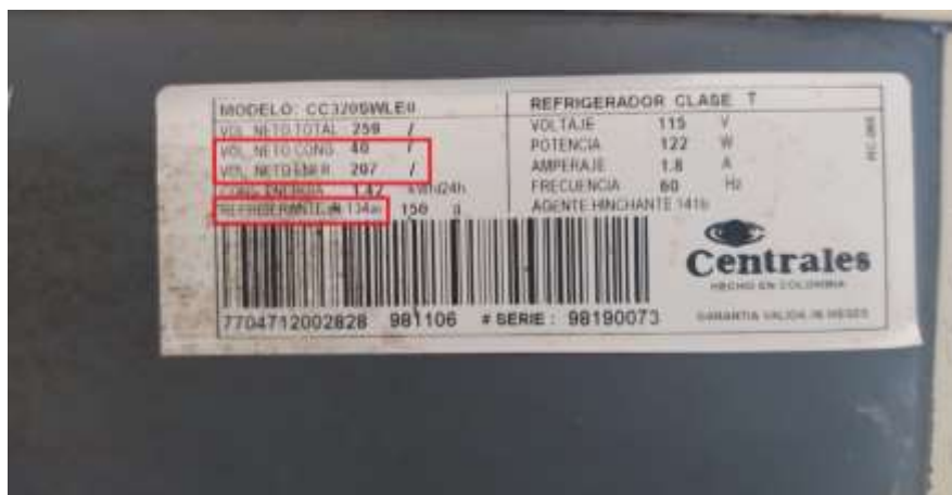
Imagen 7 Placa de la nevera donde se evidencia la capacidad de almacenamiento nominal y el tipo de refrigerante.
